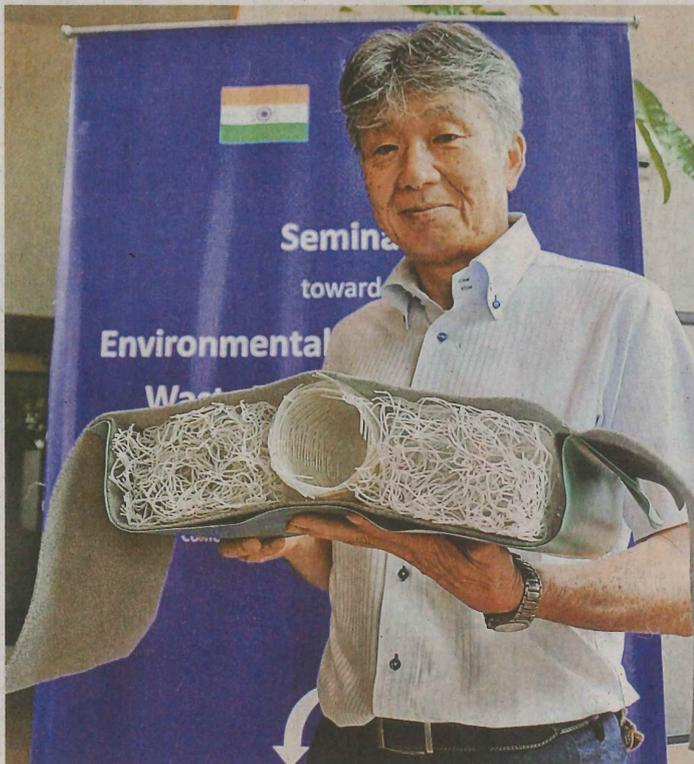
汚水処理装置で処理水を土壤に染み込ませる役割を担う「タフガード」=米子市米原6丁目の大成工業
